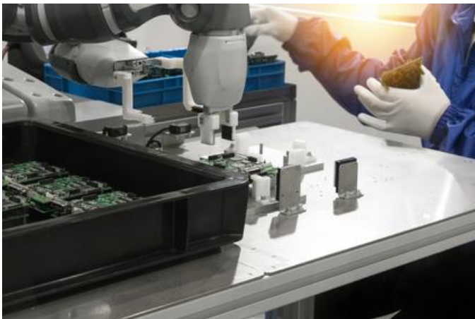
Un cobot care lucrează alături de un om pentru a asambla componente electronice.
